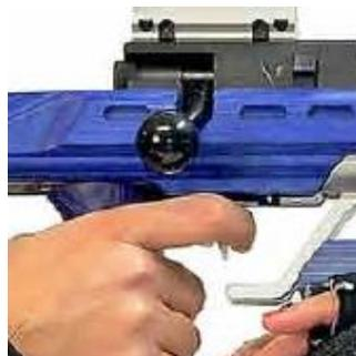
Die Lautstärke des Auslöse-Geräusches ist von Sportgerät zu Sportgerät verschieden und kann in der Software in einem weiten Bereich eingestellt werden. Bei Sportgeräten mit einem sehr leisen Geräusch ist es wichtig, dass der Sensor mechanisch-akustisch möglichst direkt am Sportgerät befestigt wird (an Metallteilen, nahe am Auslösesystem). Beim scharfen Schuss reicht der Impuls natürlich bei Weitem aus.
